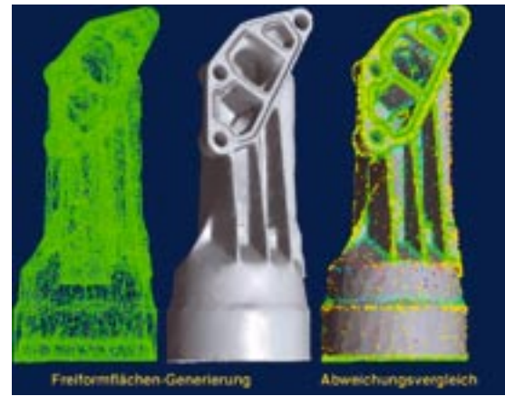
AUTOMATISCHER SOLL-IST-VERGLEICH DES CAD-MO- DELLS UND TOMOGRAMMS EINES LEICHTMETALL- GUSSTEILS: GEOMETRISCHE ABWEICHUNGEN WERDEN DURCH FARBIGE MARKIERUNGEN HERVORGEHOBEN. EINE GRÜNE FÄRBUNG ENTSPRICHT HIERBEI EINER NUR GERINGEN ABWEICHUNG.
