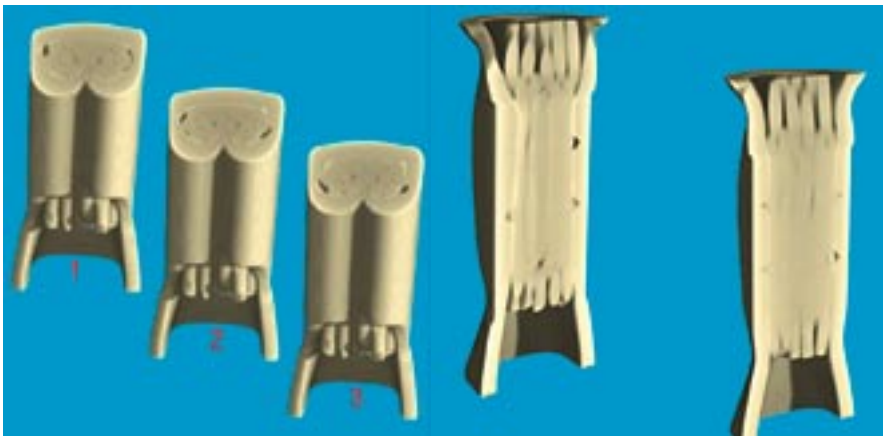
3D-TOMOGRAMM EINES ELEKTRISCHEN CRIMP-VERBINDERS: IN DEM VERPRESSTEN BEREICH LIEGEN HOHLRÄU- ME ZWISCHEN DEN EINZELNEN LITZEN VOR. DIE CT-UNTERSUCHUNG BIETET GEGENÜBER DER TRADITIONELLEN SCHLIFFPRÄPARATION DEN VORTEIL, DASS DIE GESAMTE VERPRESSTE CRIMPZONE BEWERTET WERDEN KANN.
